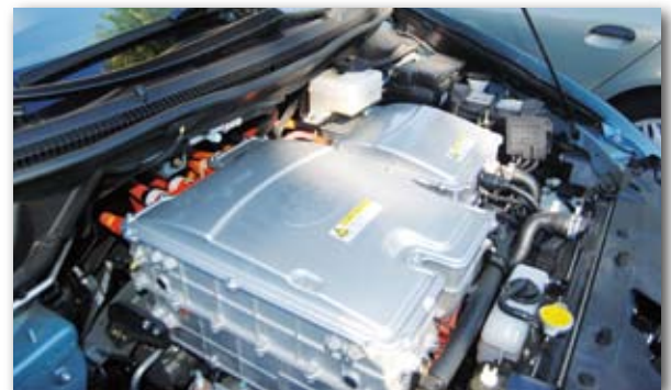
La potencia del E6 es de 75 kw, el equivalente a 100-105 CV
