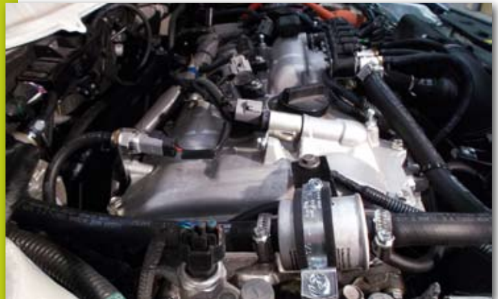
Vano motor Toyota Prius transformado a GLP.
